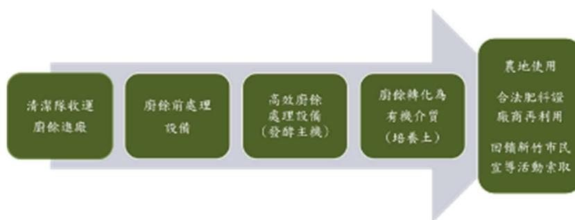
圖 3-4 高效廚餘處理廠區作業流程圖
